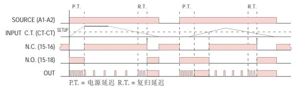
3. 启动NC-欠电流NO-电源延迟
