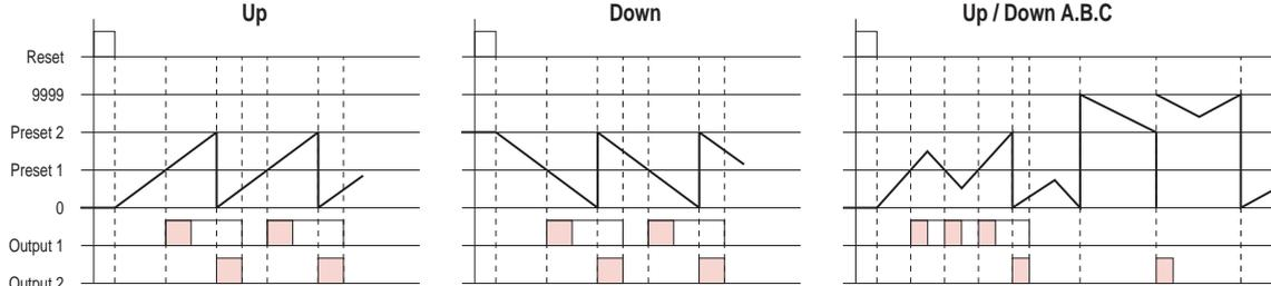
输出模式 **R**: 显示值在单一输出时间后回到Reset起始状态。输出动作为重复单击输出。
