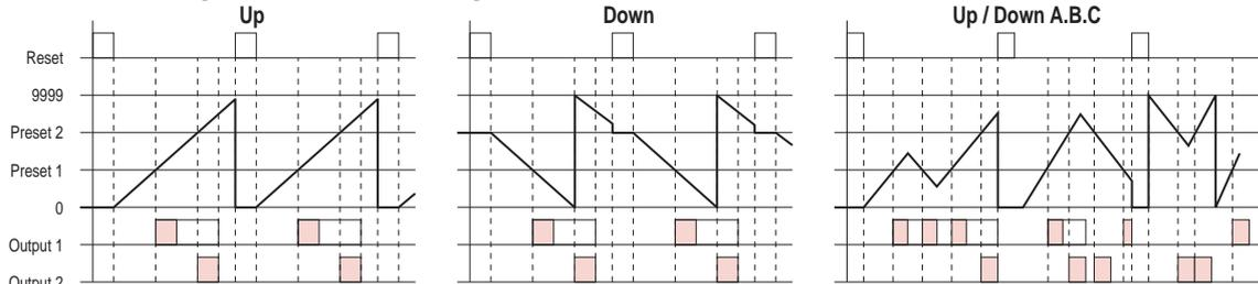
输出模式 **P**: 显示值在单击输出时间内不会改变, 但计数完成同时回到Reset起始状态。输出动作为重复单击输出。
