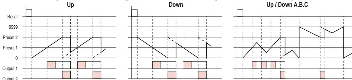
**输出模式Q**：显示值会持续计数，而单击输出时间后回到Reset起始状态。输出动作为重复单击输出。
