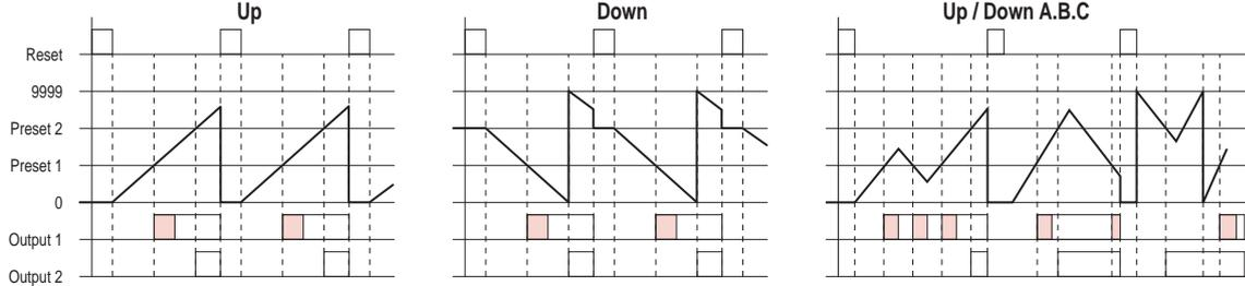
输出模式 **C**: 显示值和计数向上同时回到Reset起始状态。不显示计数向上之值。输出动作为重复单击输出。
