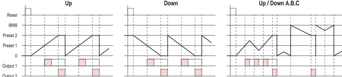
输出模式 **K**: 显示值持续计数。Output1自保持输出, 在Output2单击输出时间后停止。
