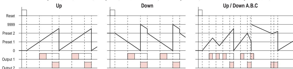
**输出模式A**：显示值与Output1自保持输出一直保持到Reset输入。Output1与Output2是各自独立的。
