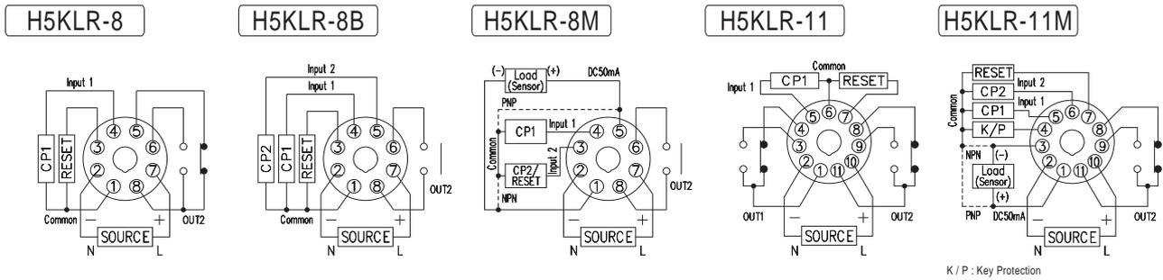
注:图中的Common在NPN型时 = 0V, 在PNP型时 = +V (NPN型与PNP型的选择可由参数设定中选择)
